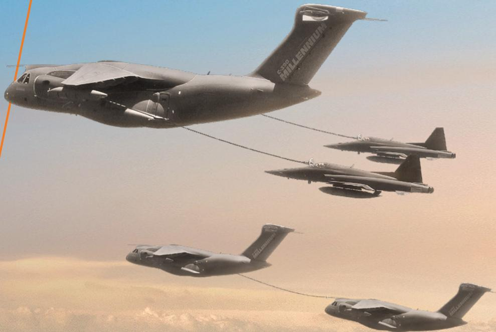
El KC-390 MILLENNIUM es capaz de reabastecer aviones tanto de ala fija como rotativa, operando a velocidades de 120 KCAS a 300 KCAS y a altitudes de 2.000 pies a 32.000 pies. La capacidad de repostaje en tierra del KC-390 MILLENNIUM puede ser utilizada para repostar vehículos o bases de operaciones avanzadas.
