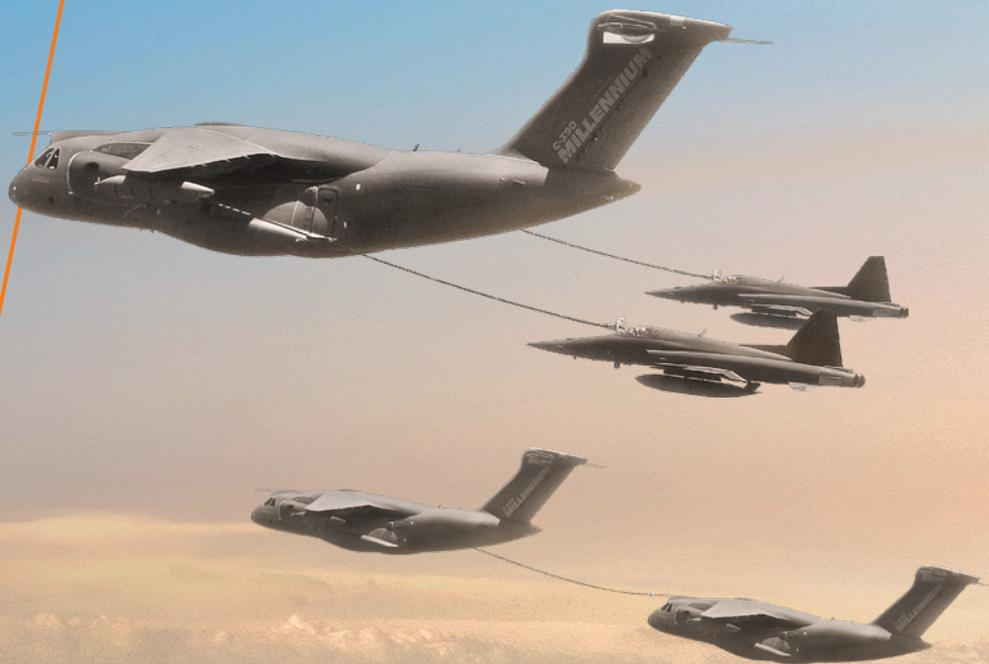
Le KC-390 MILLENNIUM est capable de ravitailler des aéronefs à voilure fixe et à voilure tournante, à des vitesses allant de 120 KCAS à 300 KCAS et à des altitudes allant de 2 000 ft à 32 000 ft. La capacité de ravitaillement au sol du KC-390 MILLENNIUM peut être utilisée pour ravitailler des véhicules ou des bases d'opérations avancées.
