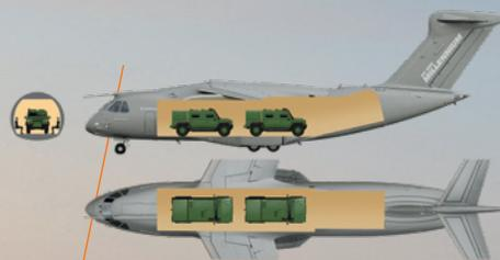
2 VÉHICULES LÉGERS MULTIRÔLES (VLP) - PAR EX., VLP IVECO
