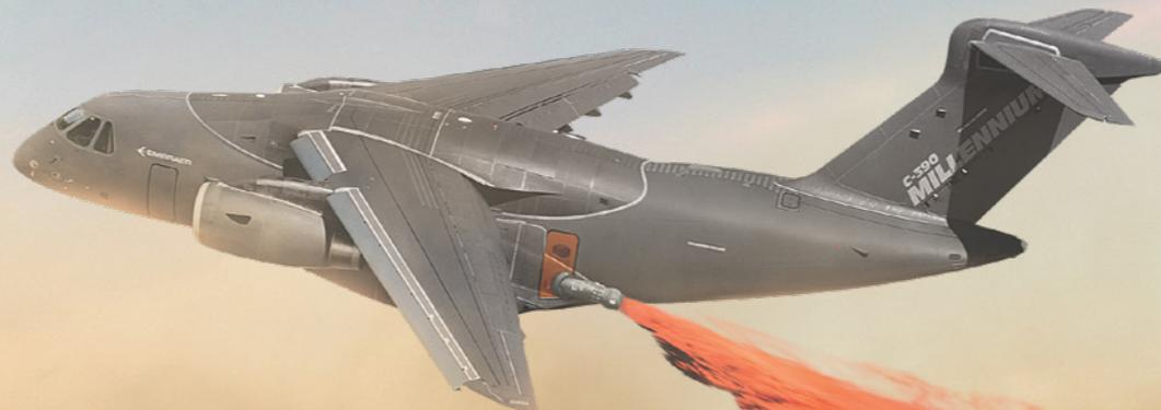
***O SISTEMA DE CONTROLE FLY-BY-WIRE DO C-390 MILLENNIUM FORNECE EXCELENTE CAPACIDADE DE MANOBRA EM BAIXAS VELOCIDADES PARA OPERAÇÃO AÉREA DE COMBATE A INCÊNDIOS***
