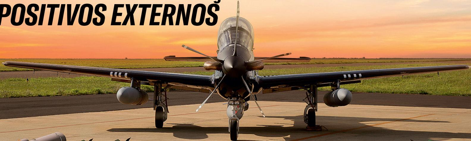
LANÇADOR DE FOGUETE 7 X 70 MM
