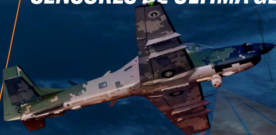
O sensor EO/IR do A-29 Super Tucano é integrado ao sistema de armas. É capaz de operar a 15.000 pés e é totalmente compatível com óculos de visão noturna (NVGs). O sistema gera fotos e vídeos de objetos a dezenas de quilômetros de distância. As opções de carga incluem termovisores, múltiplas cargas de laser e outros sistemas avançados.
